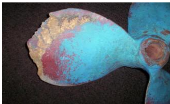
شکل ۲- نمایی از پروانه تخریب شده با کاویتاسیون [۱]
